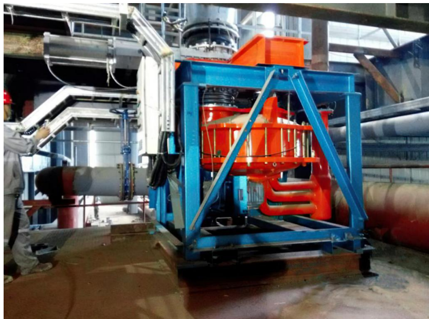
图3 江苏德龙镍业有限公司CWF1000稳流型煤粉计量秤（印尼现场）
